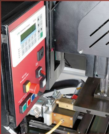
Участок заливки со свободным доступом обеспечивает максимальную универсальность при компоновке формы.
