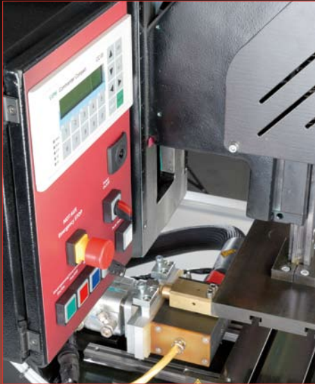
Frei zugänglicher Vergussbereich bietet höchstmögliche Flexibilität im Werkzeuglayout.
